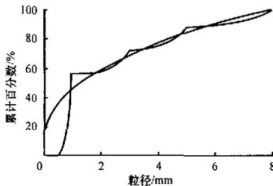
图 1 最优配比的粒度分布与紧密堆积的粒度分布比较
