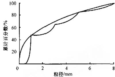
图 2 经验配比的粒度分布与紧密堆积的粒度分布比较
